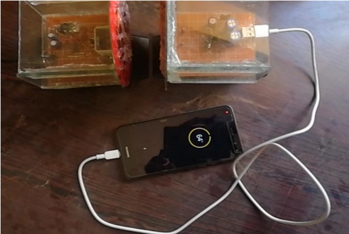
الشكل (4-5): الشاحن اللاسلكي أثناء التجربة
