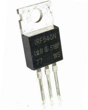
الشكل (2-3): تركيب ترانزستور IRF540N
