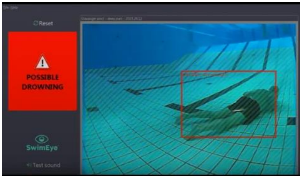
الشكل (1-2) نظام كشف الغرق التلقائي المعتمد على تقنية الفيديو
