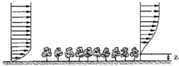
شكل رقم (2-3): يوضح تأثير خشونة الأرض على توزيع الرياح .
