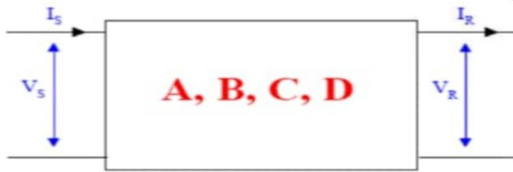
شكل(3-13) الدائرة المكافئة والثوابت العامة لخط النقل الطويل
