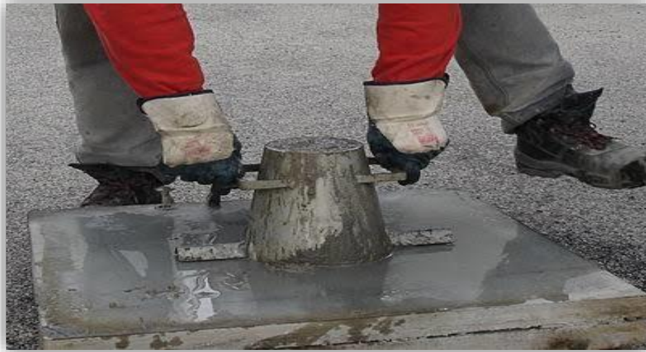
الشكل (3-3) رفع القالب بعد ملئه في الشكل
