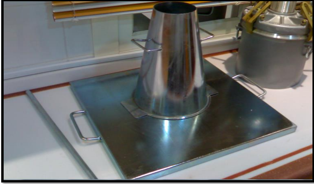
الشكل (2-3): قالب اختبار الهبوط وقضيب الدمك
