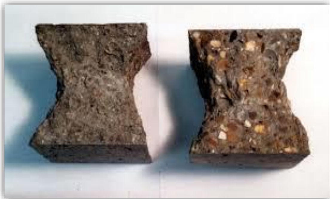
الشكل (8-3) الكسر للعينات المكعبة في اختبار مقاومة الضغط.
