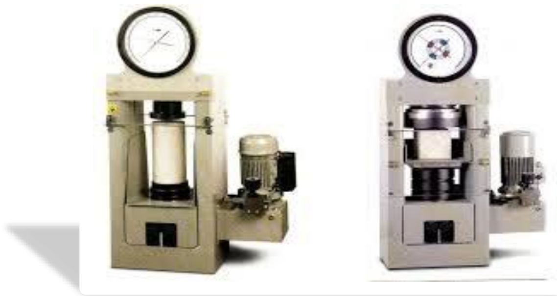
الشكل (7-3) وضع للعينات المكعبة والاسطوانية في ماكينة الضغط.
