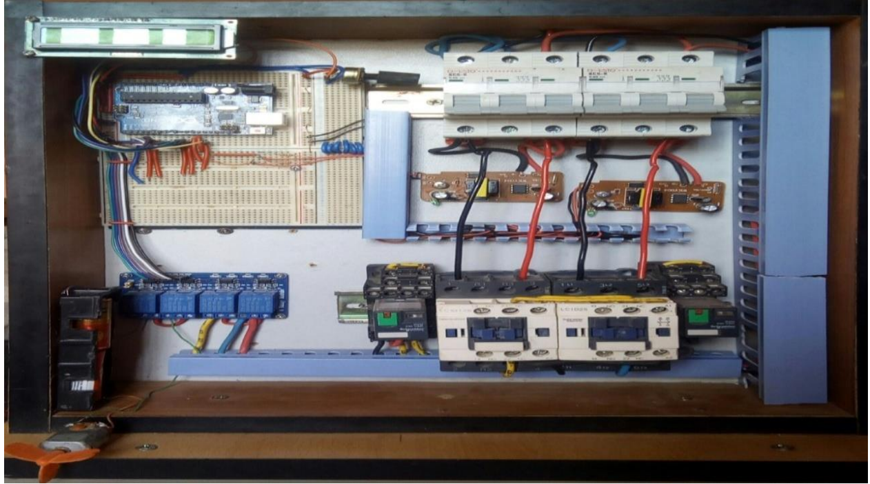
شكل ( ٤-١): يوضح الدائرة العملية لمفتاح التبديل الآلي
