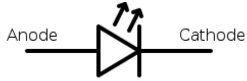
الشكل (7-3) يوضح الثنائي الضوئي ورمزه
