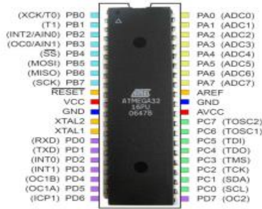
الشكل (7-3) يوضح المتحكم AT mega32.
