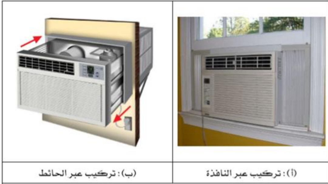
الشكل (1-2) يوضح طرق تركيب المكيفات الشبائكة
