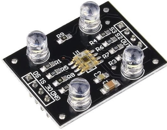
الشكل رقم (2-3) وحدة حساس الألوان TCS230
