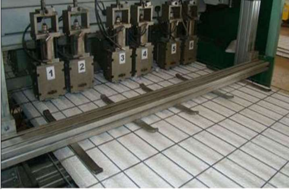
الصورة (2-1) توضح ماكينة سحب الاسلاك وماكينة الكبس
