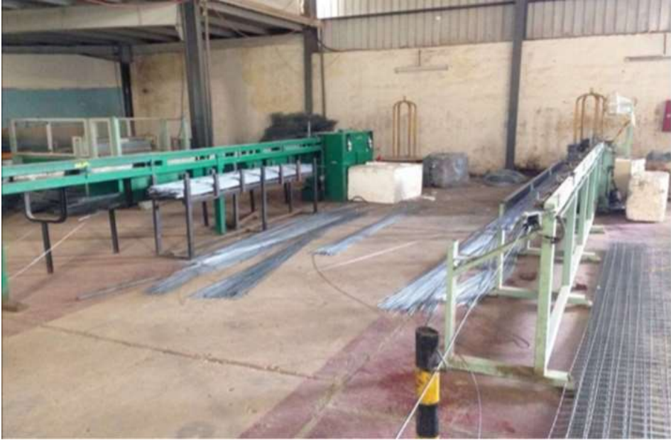
الصورة (2-2) توضح اسلاك الفولاذ بعد السحب
