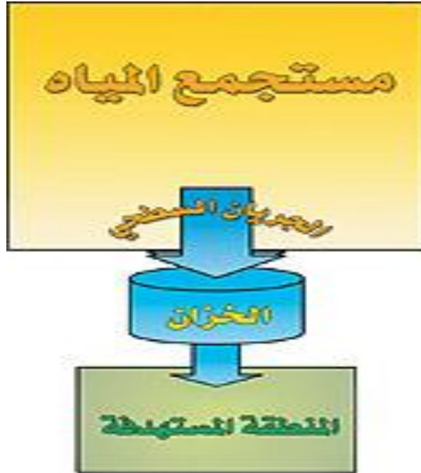
شكل رقم ( 2-1 ) يوضح مكونات نظم حصاد المياه
