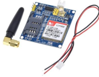
الشكل (4-3) يوضح GSM sim900
