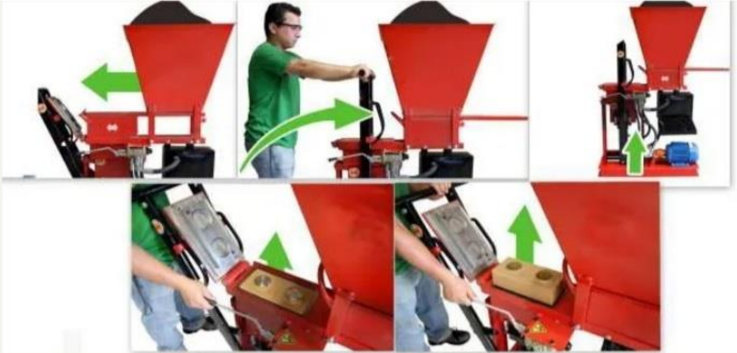
الشكل (3-6) يوضح طريقة عمل الماكينة اليدوية
