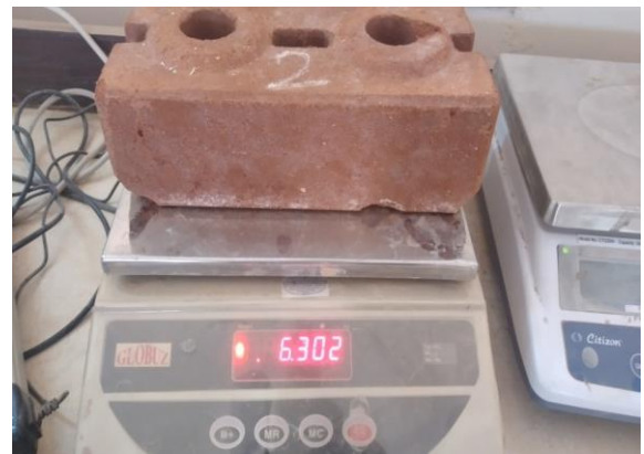
الشكل (4-2) يوضح وزن العينة رطبة
