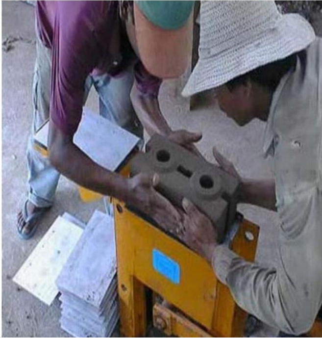
الشكل (3-3) يوضح طريقة تشغيل المكبس
