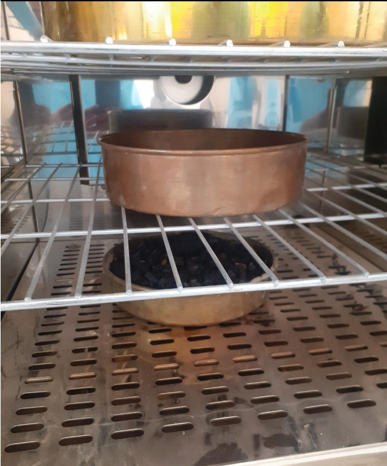
الشكل(4) يوضح وضع عينة الركام المكسور في الفرن
