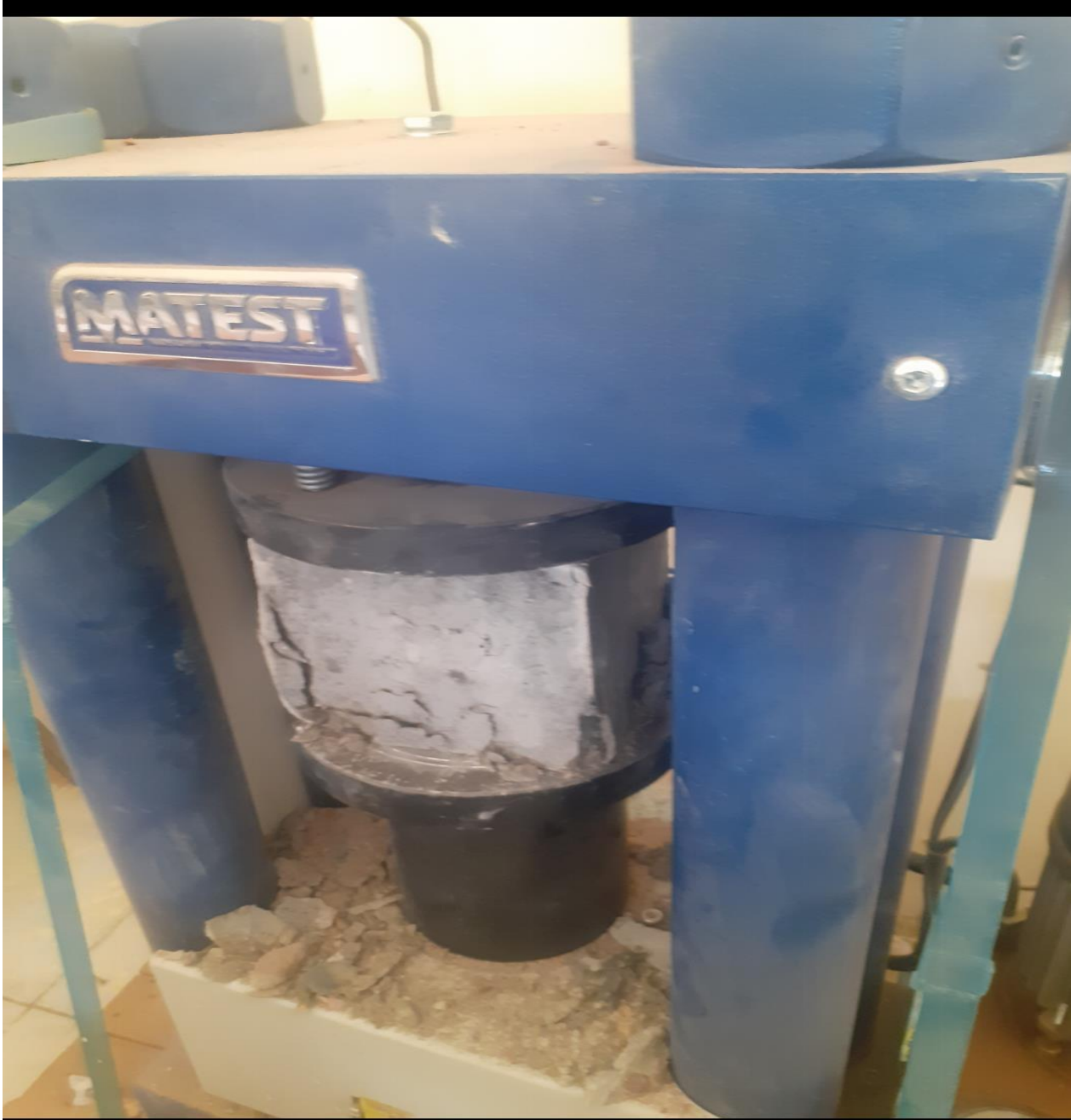
الشكل (6) يوضح إختبار مقاومة الضغط علي أحد العينات
