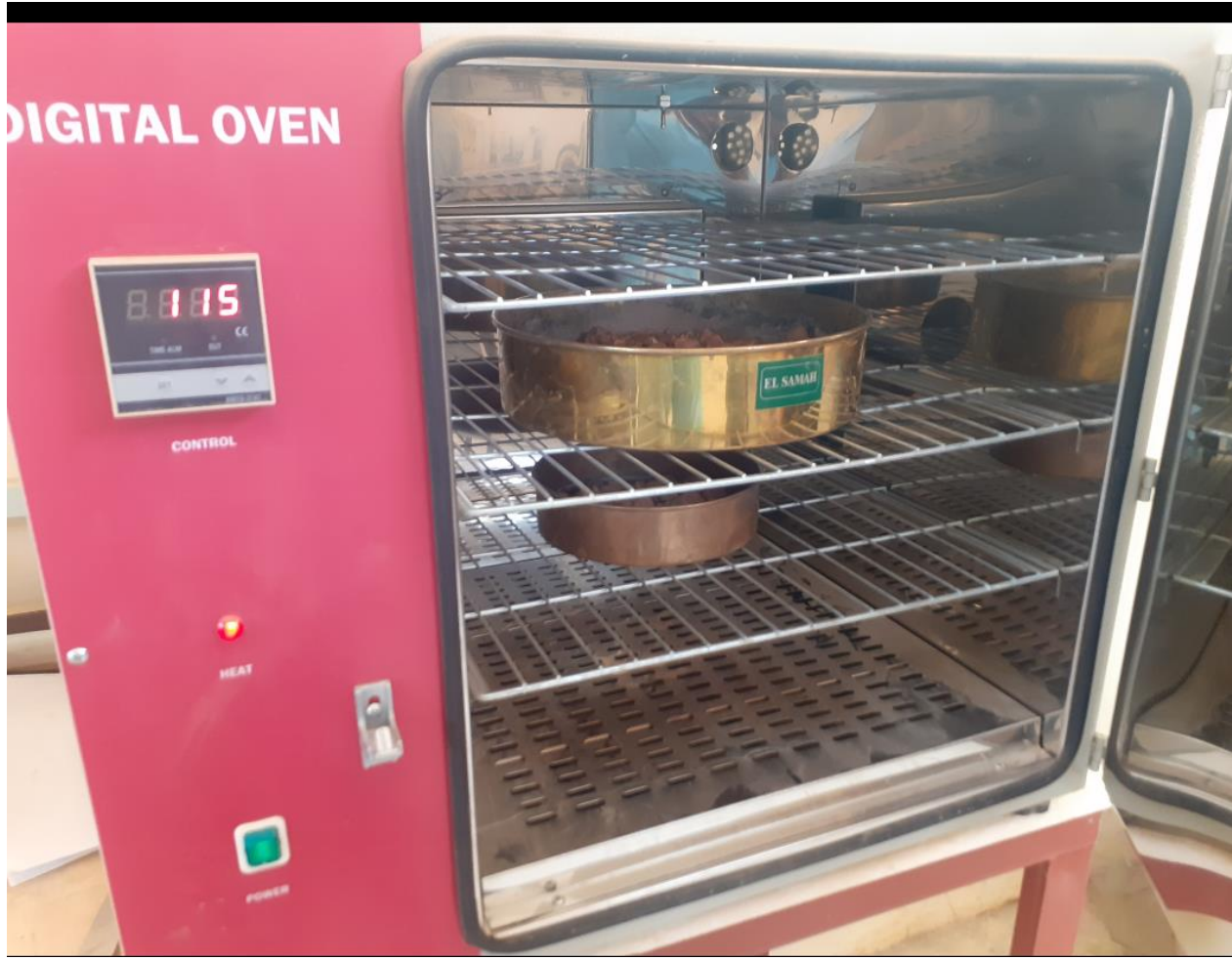
الشكل (5) يوضح وضع عينة الركام الغير مكسور داخل الفرن
