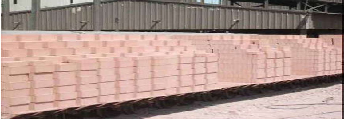
شكل (2-7) يوضح الطوب الرملي الجيري
