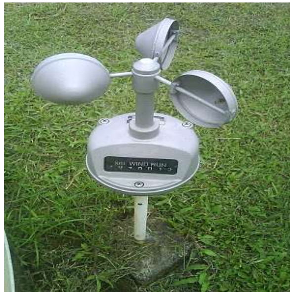
شكل (3.4) يوضح جهاز قياس ذو الطاسات المجوفة
