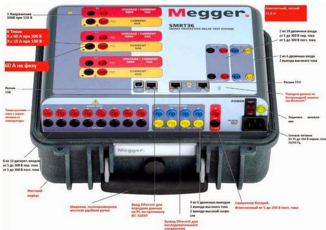
ملحق (D): شرح أجزاء جهاز Adapter Megger Smart
