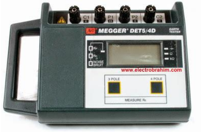
ملحق (B): جهاز Megger EDT5/4D لقياس واختبار مقاومة التأسيس
