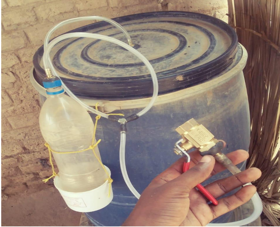
الشكل (1-4) هاضم لا هوائي من المواد المحلية
