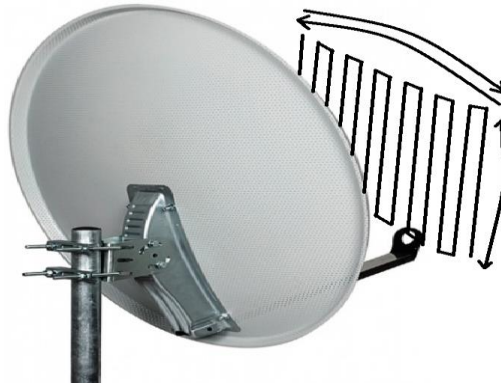
الشكل (4-16) حركة الهوائي أثناء عملية البحث
