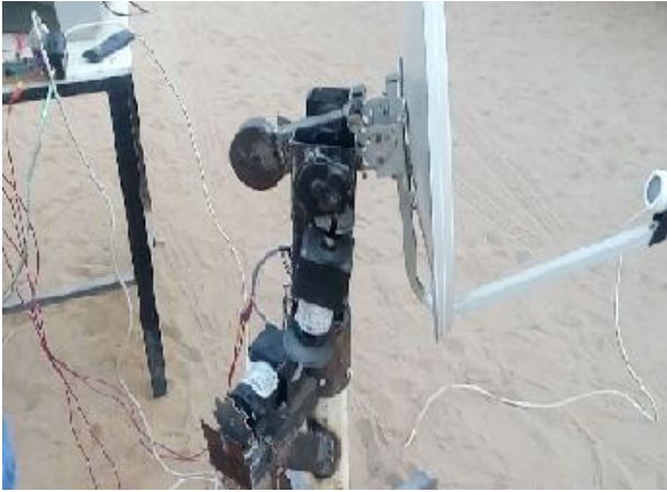
الشكل (4-15) الهوائي المستخدم في النظام
