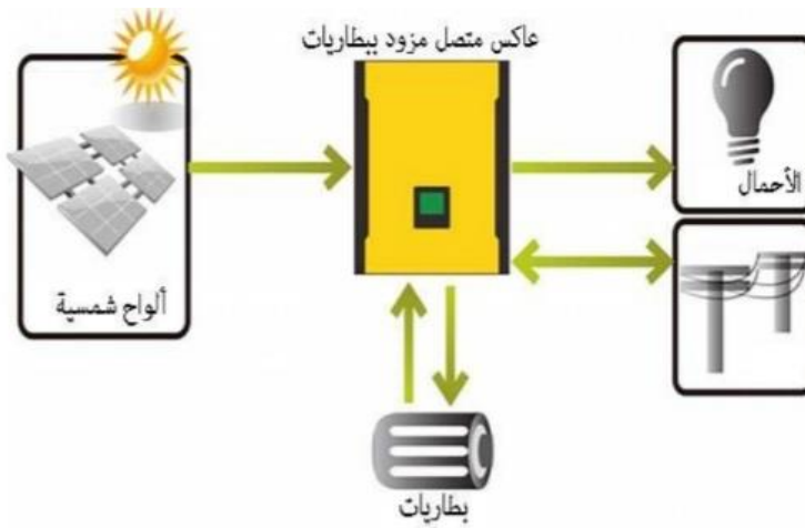
الشكل (3-19): عاكس متصل بالشبكة مزود ببطاريات
