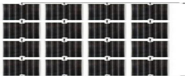
الشكل (3-6) : توصيل الخلايا علي التوالي توازي
