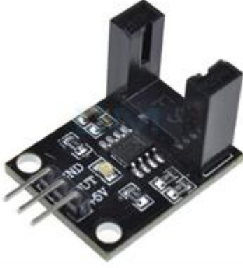
الشكل 8.3 يوضح حساس ضوئي Lm 393
