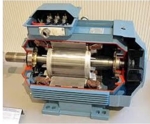
الشكل 3.3 يوضح التركيب الداخلي للموتور ثلاثي الطور
