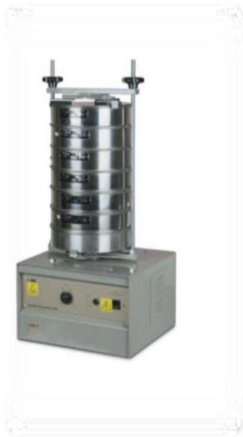
شكل رقم (٢-٢) يوضح: مجموعة من المناخل القياسية
