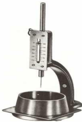
شكل رقم (٣-٣) توضيح: جهاز فيكات لتعيين القوام القياسي وتعيين زمن شك للأسمنت
