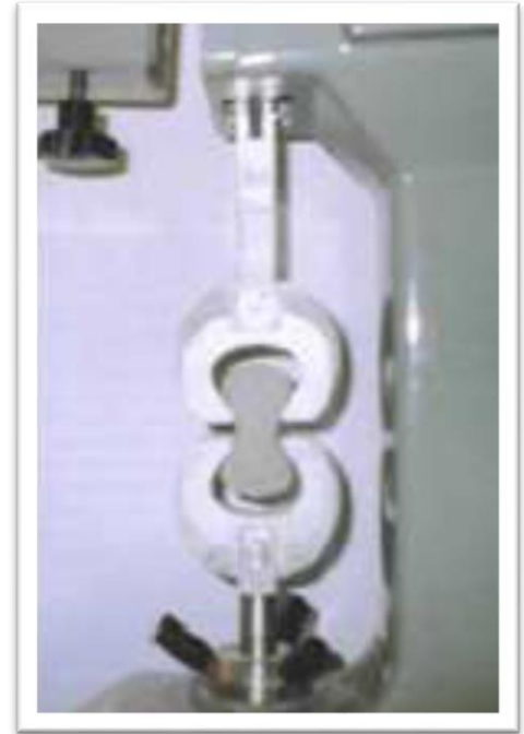
شكل رقم (٧-٣) توضح قالب عينة مقاومة الشد وكلاية ماكينة مقاومة الشد للمونة الأسمنتية
