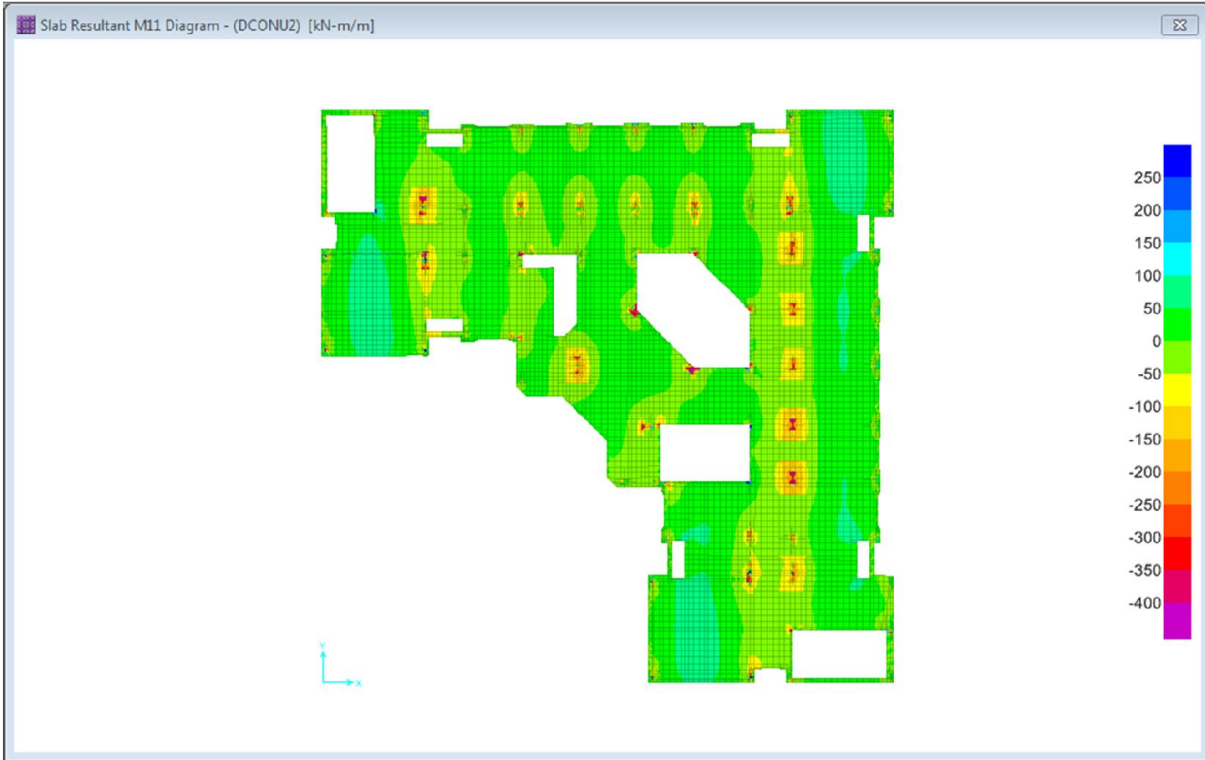
الشكل (8-3) يوضح نتائج تحليل العزوم في إتجاه المحور (x-x).
