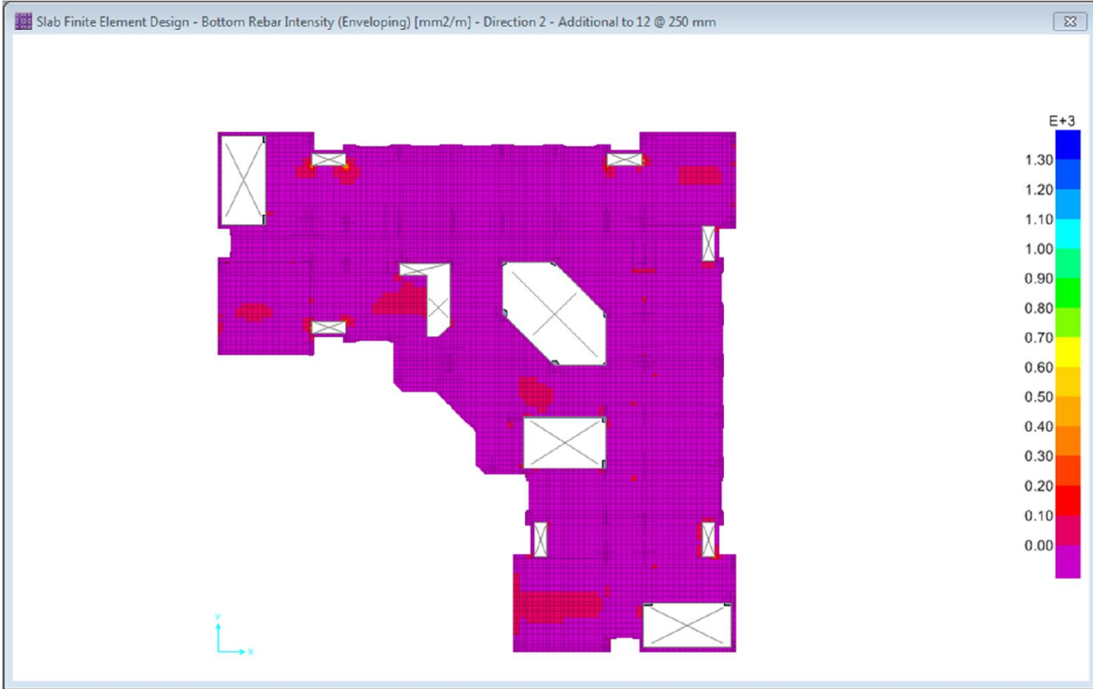
شكل (3-4) يوضح التسليح السفلي للبلاطة في إتجاه (y-y)
